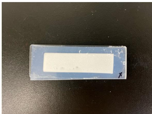
図 1 MgCl<sub>2</sub> 添加溶媒により調製した ZB ハイドロゲル
